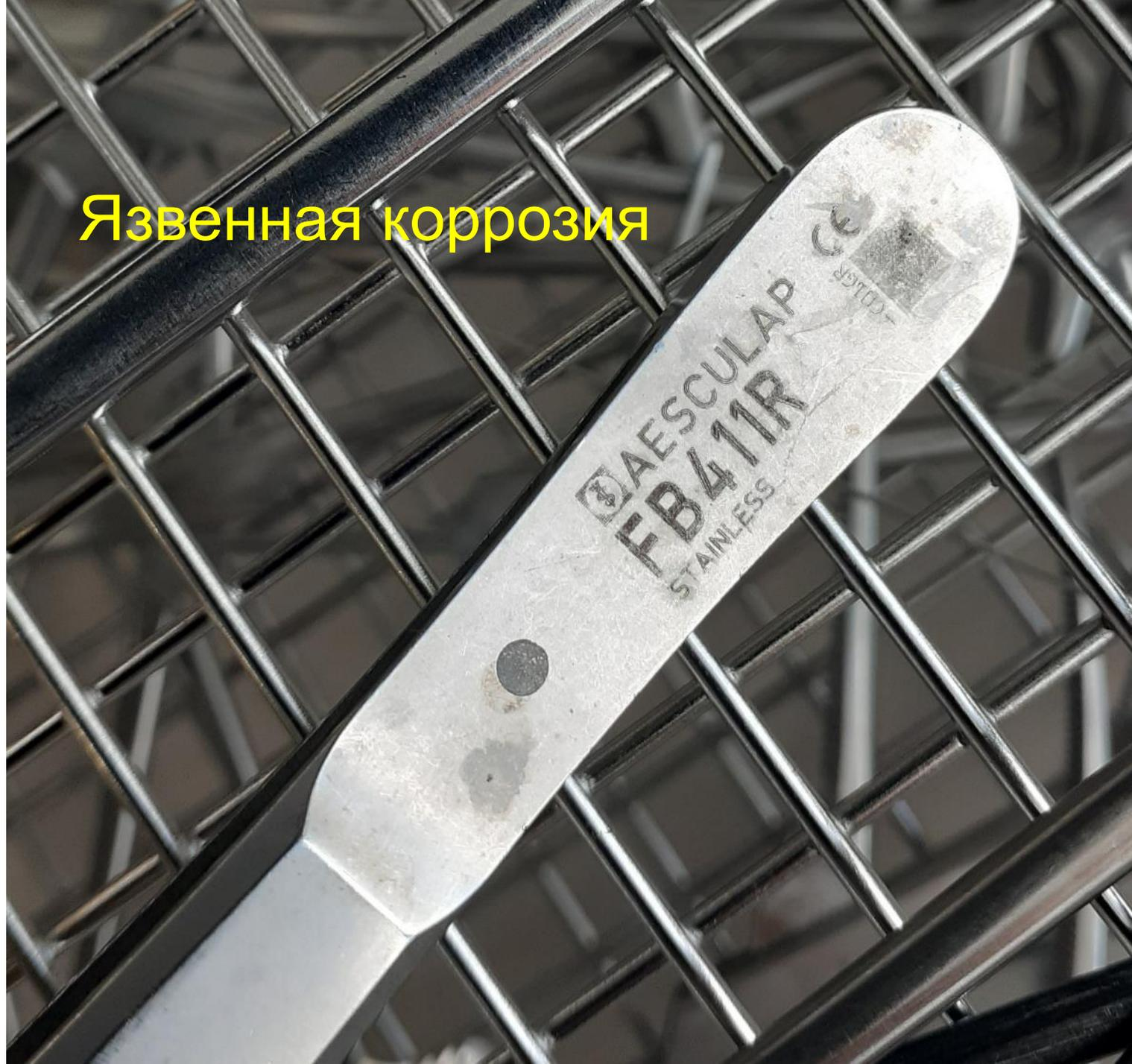
Разрушение инструмента из-за коррозии
